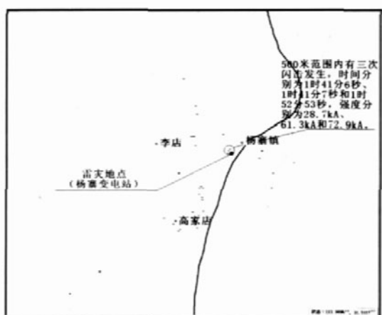
图 4 2007 年 7 月 25 日以杨寨变电站为圆心半径 1 km 范围内闪电出现位置
